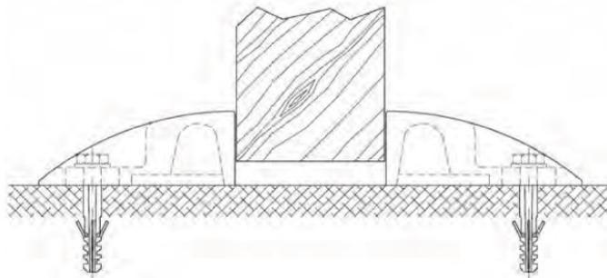
Die oben erwähnten unteren Führungsmöglichkeiten eignen sich für Schiebetore im Innen- und Außenbereich. Somit wird eine Ablagerung von Schmutz, Wasser oder Eis verhindert, und die Montage ist schnell und leicht.
