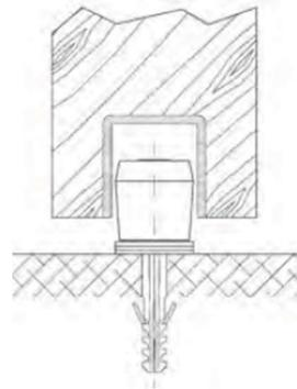
Führungsrolle aus Nylon oder Messing mit Dübel (.N58 oder .M58)
