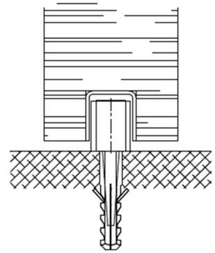
Gleitstück mit Dübel und Senk Kopfschrauben (.U54)
